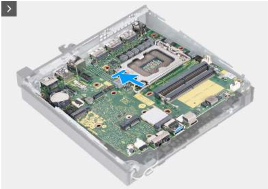
Figura 48. Como instalar a placa de sistema
