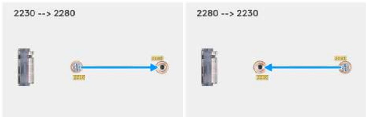
Figura 27. Como mover a montagem do parafuso para comportar um formato diferente (OptiPlex Micro 7020)
