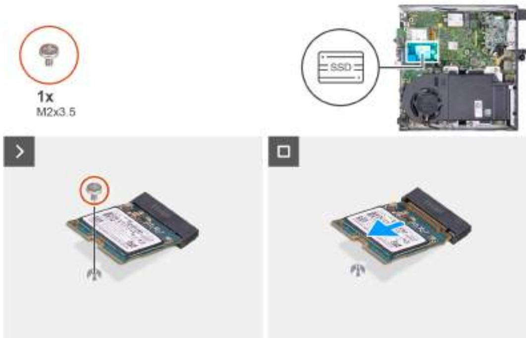
**Figura 19. Como remover a unidade de estado sólido 2230 do slot 0**
