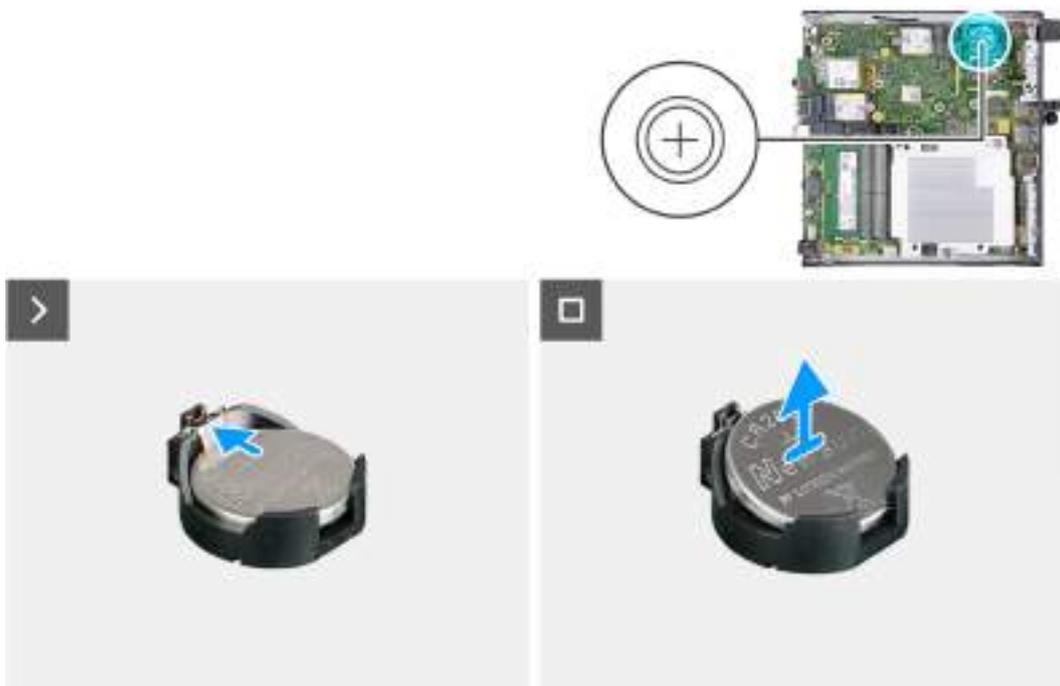
Figura 13. Como remover a bateria de célula tipo moeda
