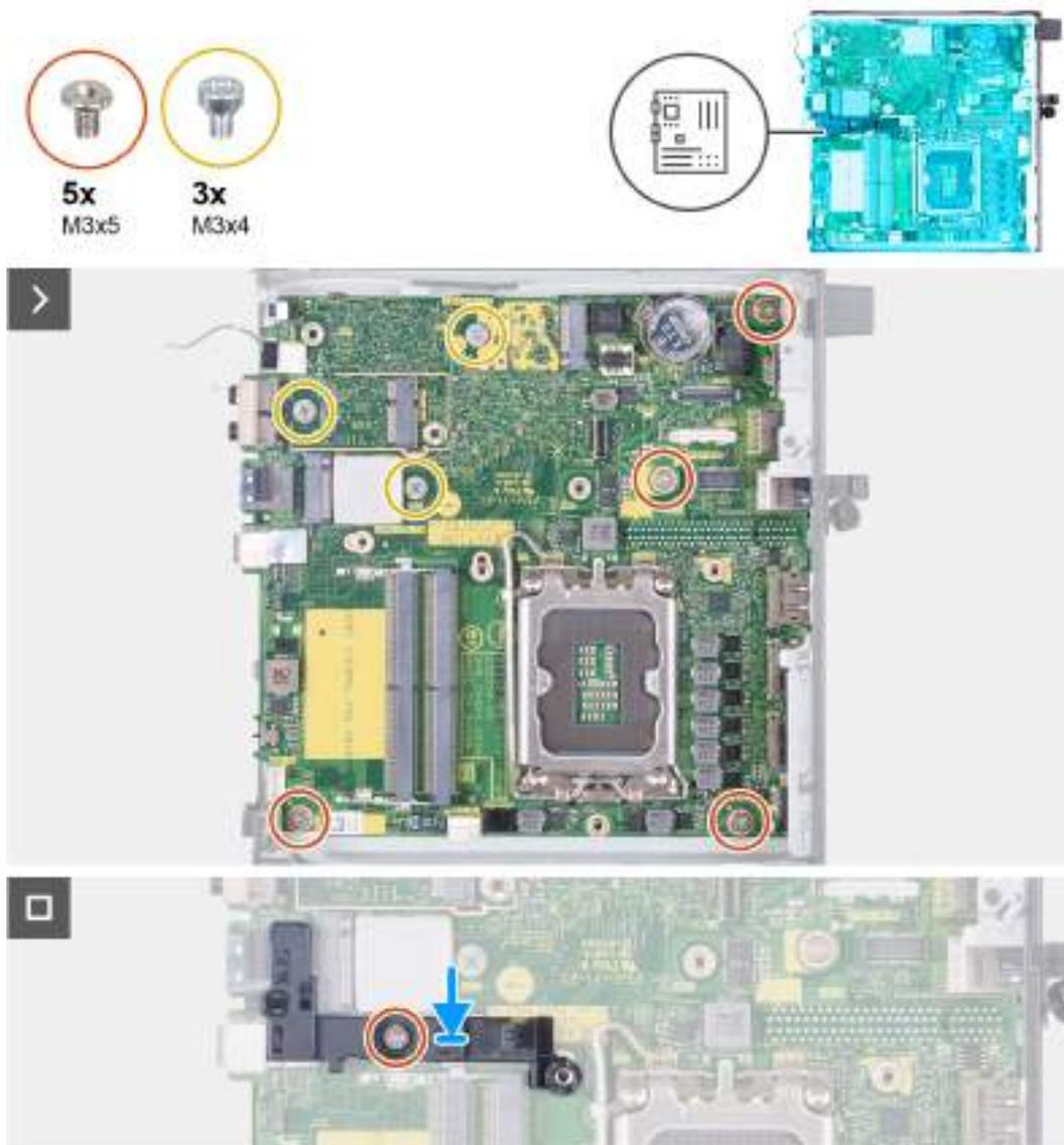
**Figura 49. Como instalar a placa de sistema**
