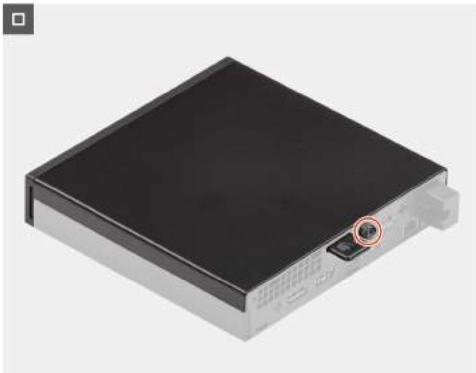
Figura 12. Como instalar a tampa lateral
