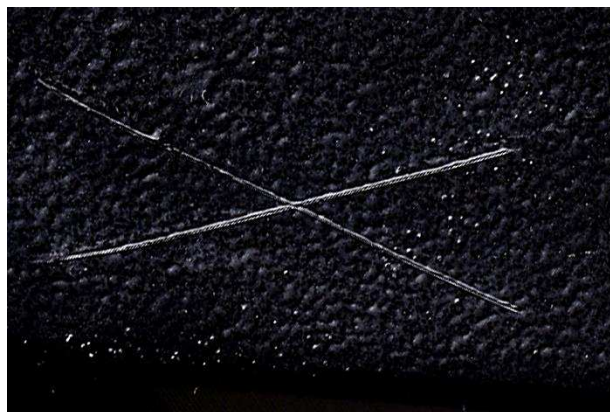
Segundo teste de aderência realizado no CPS 3. Classificação X_0/Y_0 (isento de destacamento).
