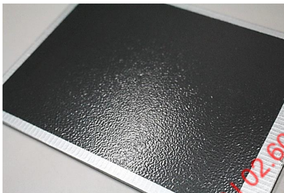
Amostra após 1368 horas de exposição. Detalhe da superfície.
