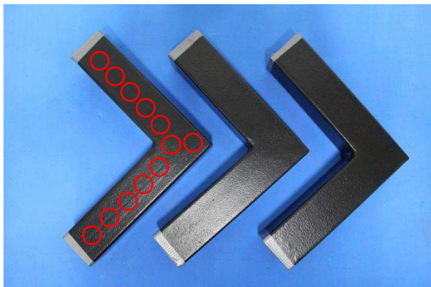
Amostra antes do ensaio. Exemplo dos locais onde as medições de espessura de camada foram realizadas.
