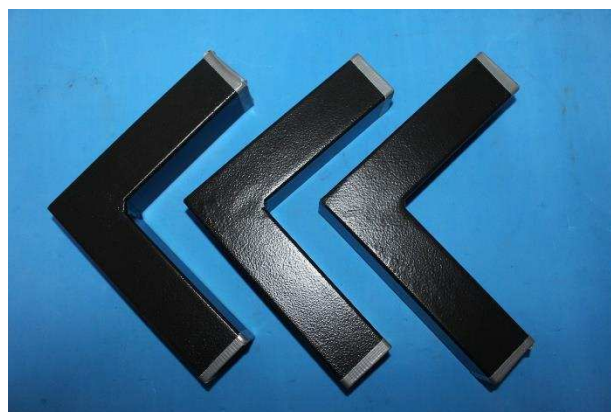
Amostra após 50 ciclos (1200 horas) de exposição.
