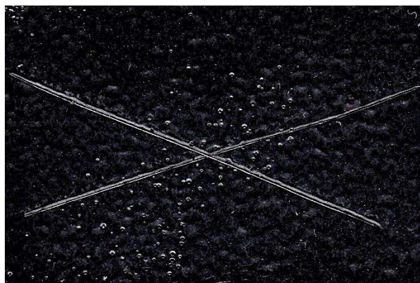
Segundo teste de aderência realizado no CPS 1. Classificação X_0/Y_0 (isento de destacamento).
