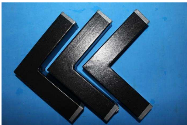
Amostra após 25 ciclos (600 horas) de exposição.
