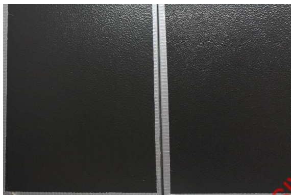
Amostra após 2500 horas de exposição. Detalhe da superfície.
