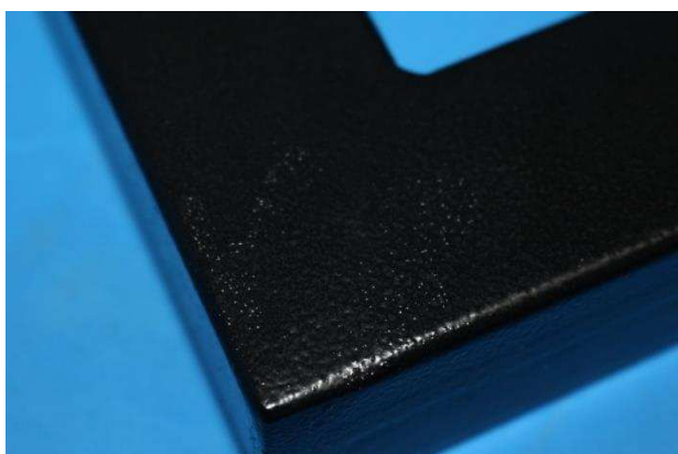
Amostra após 50 ciclos (1200 horas) de exposição. Detalhe da superfície.
