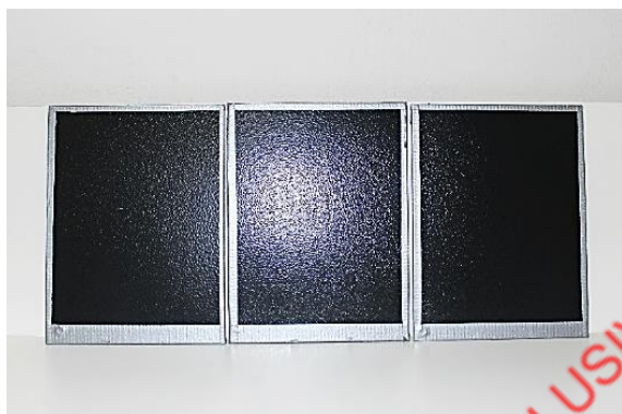
Amostra após 456 horas de exposição.
