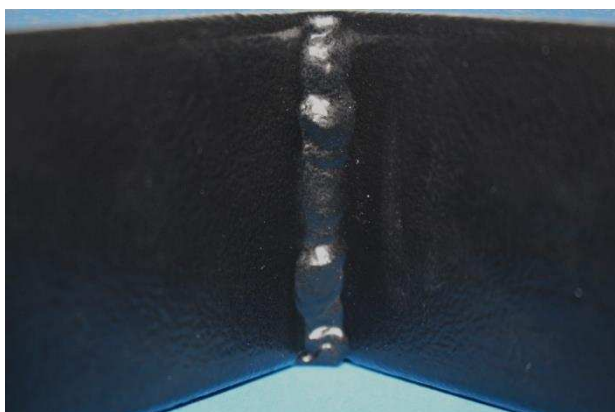
Amostra após 25 ciclos (600 horas) de exposição. Detalhe da superfície.
