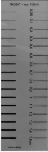
**Calibre Para Medir Fissuras**
