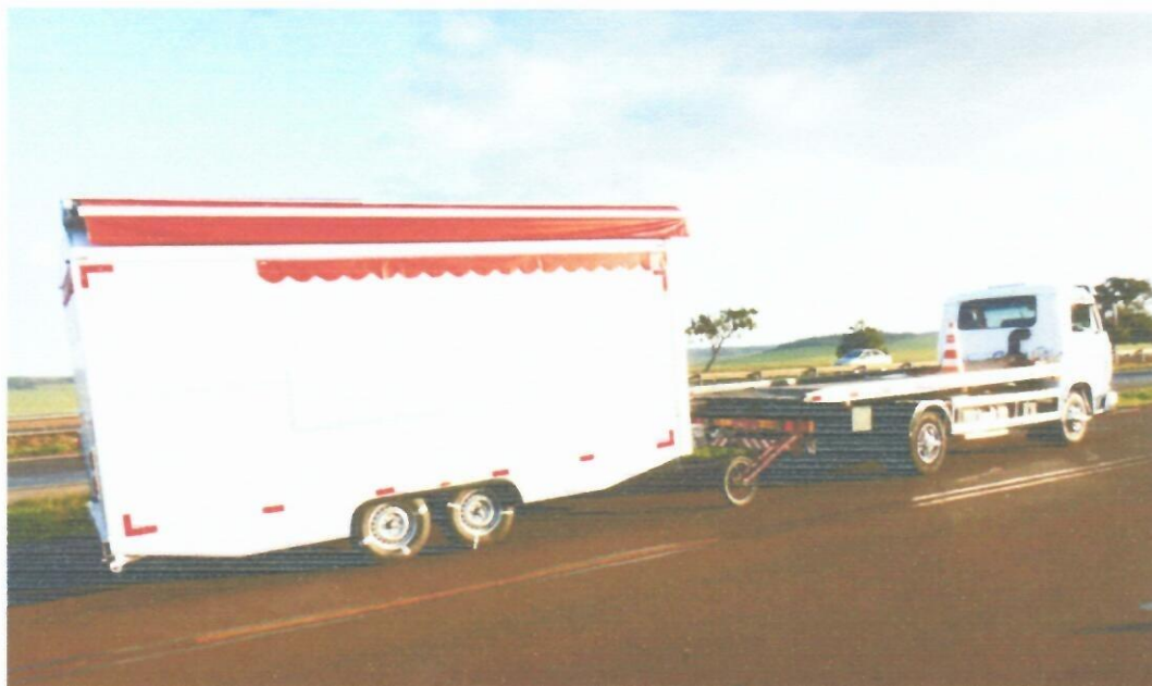
Figura 3. Trailer Carretas Russo durante ensaio de Freios em Pista
