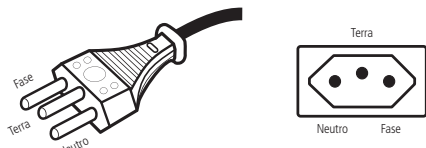
Plugue do cabo de força de acordo com padrão NBR 14136
