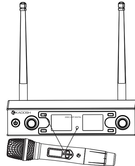
Pressione o botão IR, ligue o microfone de mão, coloque o Handheld de forma que enxergue o LED de IR da base. Aguarde o processo de Sync finalizar.
