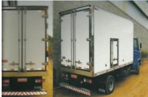
Carroceria monobloco em estrutura básica em aço, perfis laterais e teto em duro alumínio, quadro traseiro, lateira e dobradiças em aço inox, revestimento interno e externo em fibra branca, isolamento interno em placas de poliuretano e fundo canaletado.
