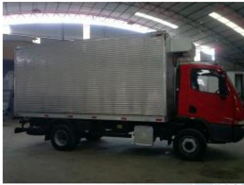
Implemento para transporte abrigado de produtos embalados, com isolamento térmico e adaptado para sistema de refrigeração. Caixa em PVC liso preenchido com poliuretano injetado, perfis em alumínio, estrutura em chapas de aço e assoalho em chapa de alumínio canaletada, lisa ou fibra de vidro.
