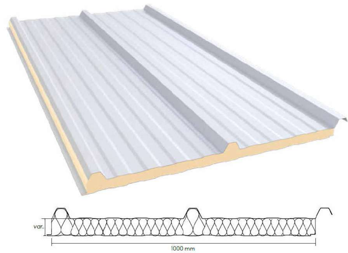
TELHA TRAPEZOIDAL PIR AP (TELHA SANDUÍCHE - COM 3 CAMADAS SENDO ACABAMENTO SUPERIOR E INFERIOR EM CHAPAS DE ALUMÍNIO PRÉ-PINTADAS E NÚCLEO ISOLANTE EM PIR)
