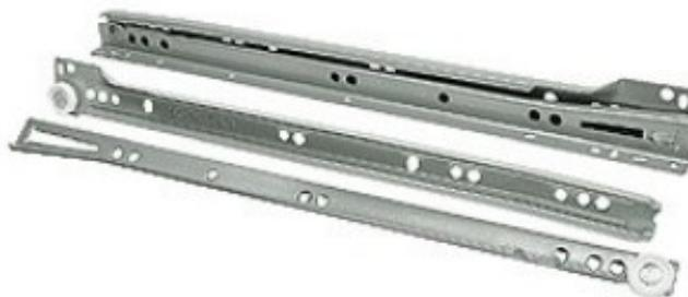
Corrediças de trilhos telescópicos fabricadas em aço que possibilite abertura total e retirada de gavetas, furação permitindo várias opções de montagem. Podem ser utilizadas nos comprimentos de 250mm a 600mm, de acordo com o tamanho da gaveta, teclado retrátil ou quadro para pasta suspensa com acabamento superficial zincado branco.
