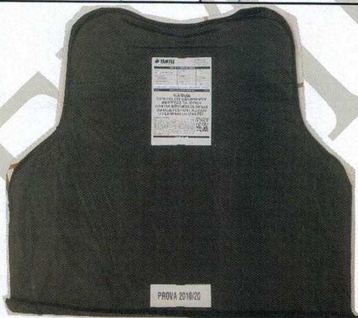
Figura 3 - Vista do painel frontal do protótipo (face de impacto)
