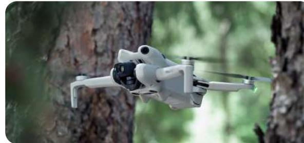
Com detecção de obstáculos omnidirecional, o **Mini 4 Pro é extremamente seguro**, pois detecta obstáculos em todos os ângulos, possibilitando frenagem automática e desvio de obstáculos de forma autônoma durante o voo com o sistema APAS.
