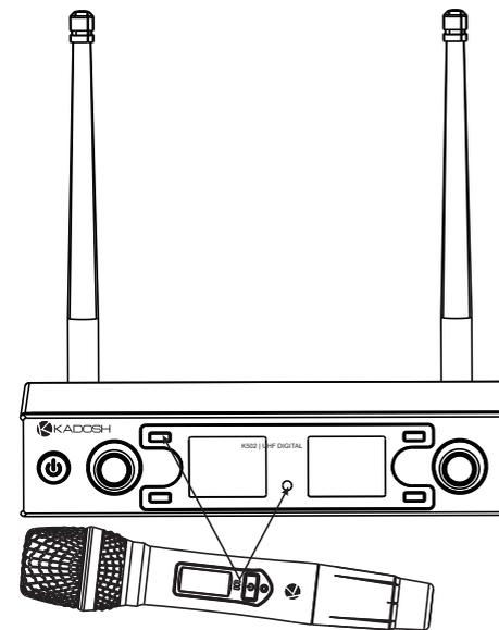
Pressione o botão IR, ligue o microfone de mão, coloque o Handheld de forma que enxergue o LED de IR da base. Aguarde o processo de Sync finalizar.
